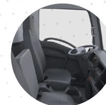
Su cabina está equipada con manijas y puntos de sujeción para una fácil entrada y salida. Adicional, sus pilares frontales verticales y el ángulo de apertura de las puertas de 90° le dan un amplio acceso.
